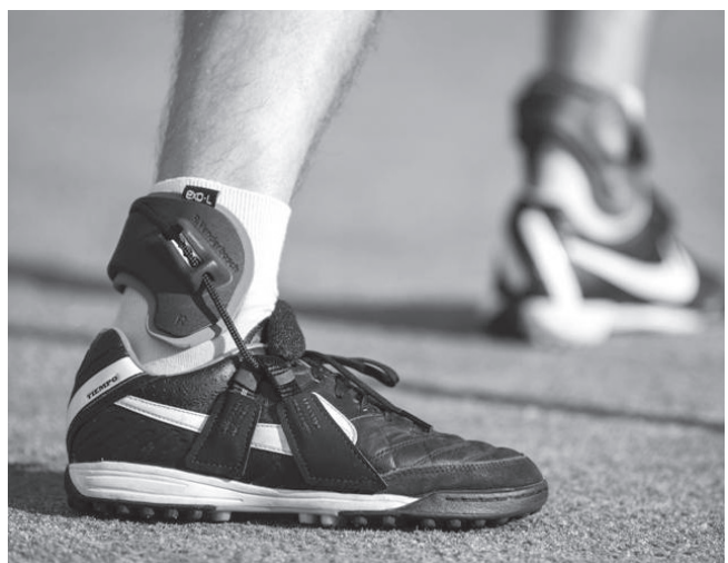
Figuur 4. De externe enkelband is via een speciale bevestiging verbonden met de schoen.
