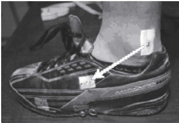
Figuur 3. Bij een (dreigend) inversietrauma neemt de afstand tussen de beide markers het sterkst toe.
