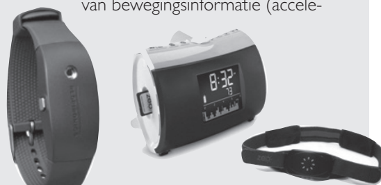
Figuur 4. Polsactigrafie (Actiwatch 2; links) en 1-kanaals EEG (Zeo Sleep Manager; rechts).
